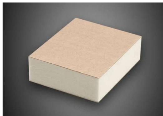
**POLIISO® PLUS** è un pannello per l'isolamento termico costituito da una schiuma polyiso (poliuretano espanso) rigida a celle chiuse, di colore giallo, espansa fra due supporti di carta metallizzata multistrato. I pannelli dichiarano valori di  $\lambda_D$  pari a 0,022 W/mK secondo la norma europea EN 13165, valori di resistenza alla compressione  $\geq 150$  kPa ed hanno dimensioni standard pari a 600 x 1200 mm o 1200 x 3000 mm. I pannelli sono disponibili negli spessori da 20 a 140 mm.
