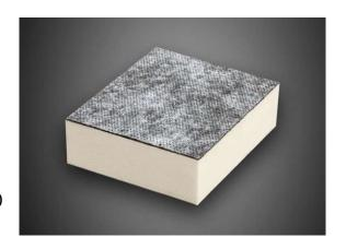
**POLIISO® SB** è un pannello per l'isolamento termico costituito da una schiuma polyiso (poliuretano espanso) rigida a celle chiuse, di colore giallo, espansa fra due supporti: quello della faccia superiore in velovetro bitumato e quello della faccia inferiore in velovetro saturato mineralizzato. I pannelli dichiarano valori di  $\lambda_D$  pari a 0,028 W/mK per spessori fino a 70 mm,  $\lambda_D$  pari a 0,026 W/mK per spessori superiori secondo la norma europea EN 13165.
