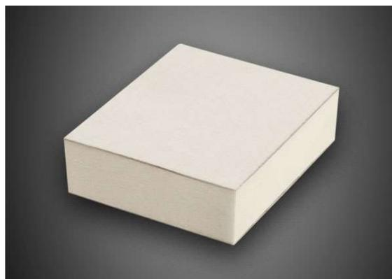
**POLIISO®VV** è un pannello per l'isolamento termico costituito da una schiuma polyiso (poliuretano espanso) rigida a celle chiuse, di colore giallo, espansa fra due supporti di velovetro saturato. I pannelli dichiarano valori di  $\lambda_D$  pari a 0,028 W/mK per spessori fino a 70 mm, 0,026 W/mK per spessori da 80 mm a 100 mm e 0,025 W/mK per spessori superiori secondo la norma europea EN 13165.
